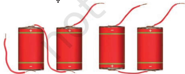
شکل 14.3 ایک بیٹری بنانے کے لیے دو سیلوں کو آپس میں جوڑنا
