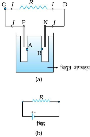
**चित्र 3.18** (a) धनात्मक टर्मिनल P तथा ऋणात्मक टर्मिनल N के साथ एक विद्युत अपघटनीय सेल का रेखा चित्र। स्पष्टता के लिए इलेक्ट्रोडों के मध्य अंतराल बढ़ाए गए हैं। विद्युत अपघट्य में A तथा B बिंदु प्रारूपिक तौर पर P एवं N के निकट हैं। (b) एक सेल का संकेत। + चिह्न P को तथा - का चिह्न N इलेक्ट्रोड को इंगित करता है। सेल के साथ विद्युतीय संयोजन P तथा N पर बनाए जाते हैं।
