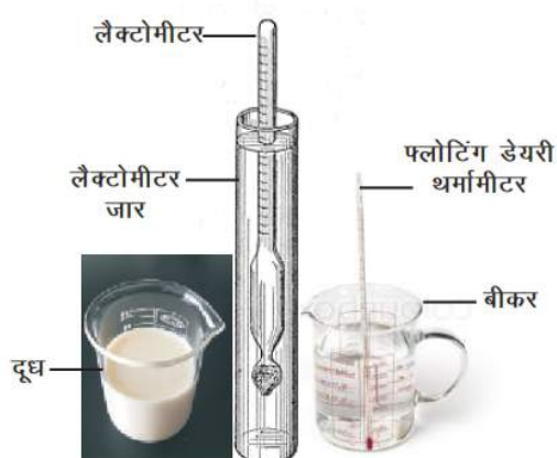
चित्र : दूध का आपेक्षिक घनत्व ज्ञात करने के उपकरण सामग्री:- 1. लैक्टोमीटर 2. डेयरी फ्लोटिंग थर्मामीटर 3.
