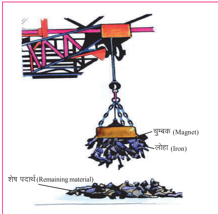
चित्र 4.4 विद्युत चुम्बक द्वारा लोहे की वस्तुओं का पृथक्करण (Separation of iron pieces using electrical magnet)
