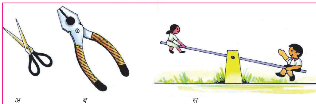
चित्र 11.9 प्रथम श्रेणी के उत्तोलक (Lever of the First kind)
