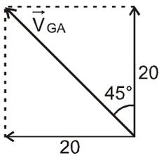
$$\vec{V}_{GD} + \vec{V}_{DC} + \vec{V}_{CB} + \vec{V}_{BA} = \vec{V}_{GA} = -\vec{V}_{AG}$$
