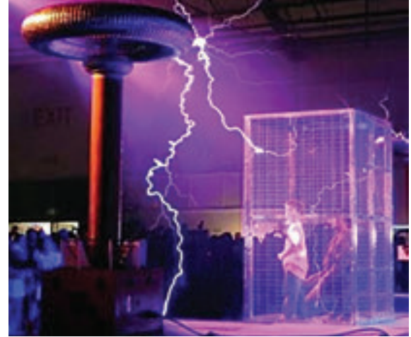
படம் 1.48 (அ) குழிவுப் பகுதியின் உட்புறம் மின்புலம் (ஆ) பாரடே கூண்டு
