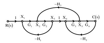
$$(A) \quad \frac{G_{1}G_{2}G_{3}G_{4}}{1\!-\!G_{1}G_{2}H_{1}\!-\!G_{3}G_{4}H_{2}\!-\!G_{2}G_{3}H_{3}\!+\!G_{1}G_{2}G_{3}G_{4}H_{1}H_{2}}$$
