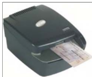
चित्र 13.4 मैग्नेटिक इंक करेक्टर रिकगनिशन
