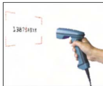
चित्र 13.5 ऑप्टिकल करेक्टर रिकगनिशन
