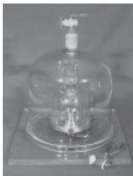
**Fig. 1.1 : Prototype of kilogram**
