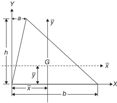
$$\bar{x} = \frac{(a+b)}{3} \quad \bar{y} = \frac{h}{3} \quad I_{\bar{x}} = \frac{bh^3}{36}.$$
