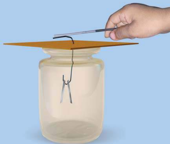
Fig 15.4 : A simple electroscope
