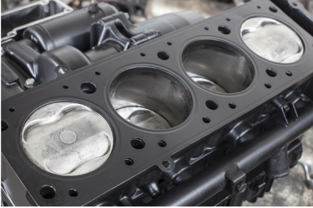
படம் (3) சிலிண்டர் பிளாக் – கரிப் படிவம் நீக்கிய பிறகு
