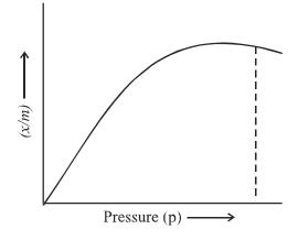
Fig. 15.7 : Langmuir Adsorption isotherm.
