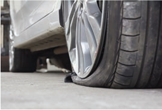
படம் 8.29 (a) டயர் வெடிக்கும்போது சூழலுக்கு வெப்பத்தைக் கடத்த நேரமின்றி டயருக்கு உள்ளே உள்ள காற்று மிக வேகமாக விரிவடையும்
