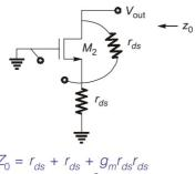
$Z_0 = r_{ds} + r_{ds} + g_m r_{ds} r_{ds}$  $= 2r_{ds} + g_m r_{ds}^2$
