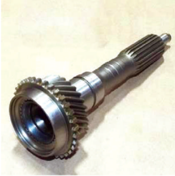
படம் 3.9.2 கியர் பாக்ஸ் இன்புட் ஷாப்ட்
