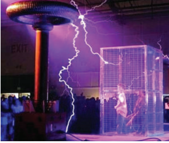
படம் 1.46 (அ) குழிவுப் பகுதியின் உட்புறம் மின்புலம் (ஆ) பாரடே கூண்டு
