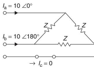
$$\begin{bmatrix} I_a^0 \\ I_a^1 \\ I_a^2 \end{bmatrix} = \frac{1}{3} \begin{bmatrix} 1 & 1 & 1 \\ 1 & a & a^2 \\ 1 & a^2 & a \end{bmatrix} \begin{bmatrix} I_a \\ I_b \\ I_c \end{bmatrix}$$
