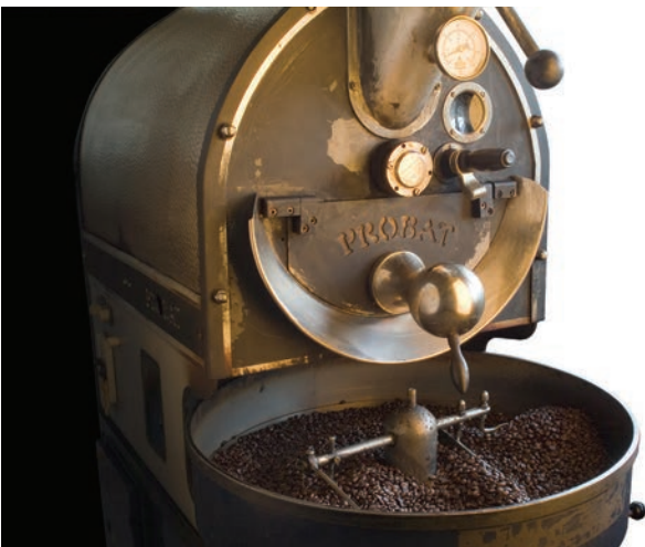
புகைபடம் 4.26 காபி கொட்டைகளை வறுக்கும் இயந்திரம்
