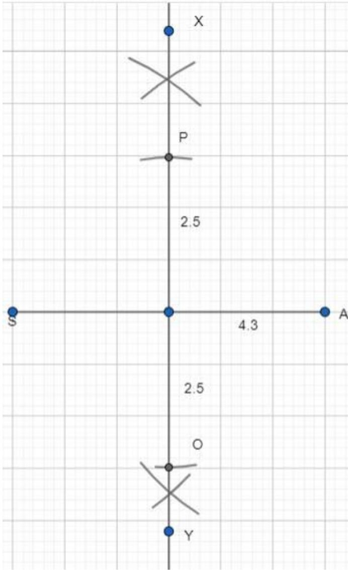
Step 4 : join  $S,O$  ;  $O,A$  ;  $A,P$  ;  $S,P$  to complete the required rhombus  $SOAP$ .
