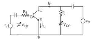
ઊપર આપેલ આકૃતિમાં  $V_{BB}$  ઉદ્દગમ 0 થી 5.0~V સુધી બદલાય છે,  $V_{CC} = 5~V$ ,  $\beta_{dc} = 200~$  અને  $R_B = 100~k\Omega$ ,  $R_C = 1~k\Omega$  અને  $V_{BE} = 1.0~V$  છે. ટ્રાન્ઝિસ્ટર સંતૃપ્ત સ્થિતિમાં પહોંચે તે માટે લઘુત્તમ બેઇઝ પ્રવાહ અને ટ્રાન્ઝિસ્ટર સંતૃપ્ત સ્થિતિમાં પહોંચે તે માટેનો ઇનપૂટ (આદાન) વોલ્ટેજ, અનુક્રમે \_\_\_\_\_\_\_ થશે.
