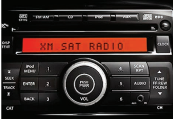
படம் 3.11 செயற்கைக்கோள் வானொலி ஏற்பி (Satellite radio receiver)
