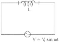
$$\therefore di = \frac{V_0}{L} \sin \omega t dt$$
