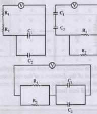
$R_1 = 1\Omega$ ,  $R_2 = 2\Omega$ ,  $C_1 = 4\mu F$ ,  $C_2 = 2\mu F$ (a) 18,4,  $\frac{8}{9}$  (b) 18,  $\frac{8}{9}$ ,4 (c) 4,18,  $\frac{8}{9}$  (d) 4,  $\frac{8}{9}$ ,18
